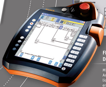
Praxisbeispiel: KUKA-Bedienpanel mit Arburg SELOGICA Oberfläche
